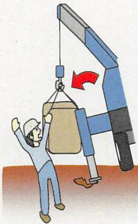
・クレーン機能付きドラグ・ショベルの荷のつり上げ作業は、必ずクレーンモードに切り替えて行ってください。
